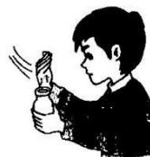
闻气体时的正确操作
